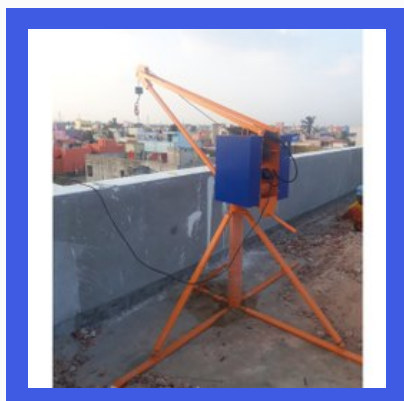
Mini Construction Lift
